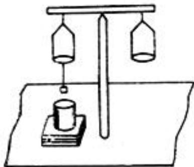
Определяют массу образца в воздухе ( $m_1$ ), накалывают на иглу образец, опускают его в стакан с водой, уравновешивают весы с образцом, погруженным в воду, и определяют массу уравновешенного груза ( $m_2$ ). При уравновешивании образец должен находиться ниже уровня воды приблизительно на 10 мм и не касаться стенок и дна стакана.
